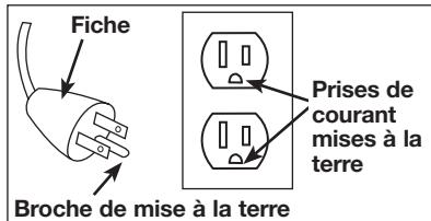
**⚠ DANGER:** Risque de choc électrique ! UNE MISE À LA TERRE INAPPROPRIÉE PEUT ENTRAÎNER DES CHOCS ÉLECTRIQUES.
